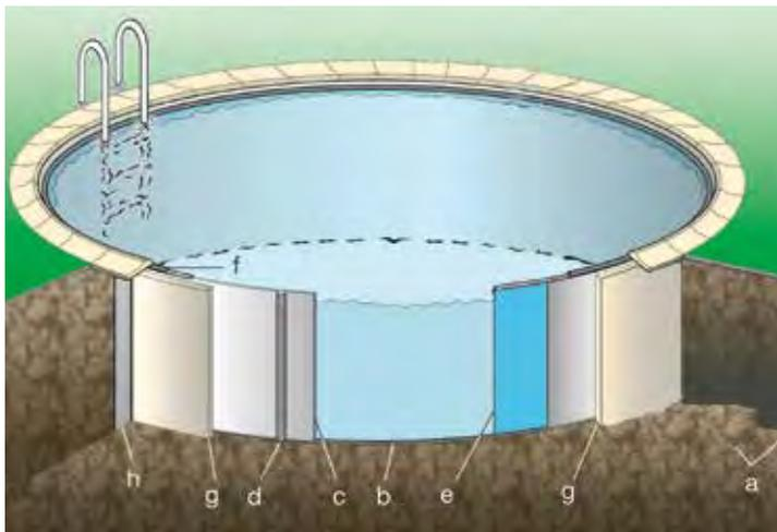
Die **Toscana Ovalformbecken** sind ausschließlich zum Erdeinbau geeignet. Seitliche Stützmauern und eine Betonbodenplatte sowie eine Magerbetonhinterfüllung sind erforderlich.
