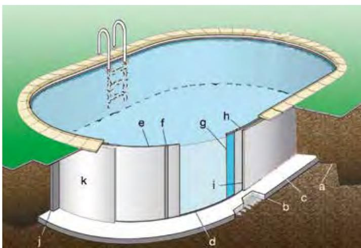
Bei den **Elba Achtformbecken** haben Sie die Wahl. Sie können das Becken komplett in das Erdreich einlassen, teilversenken oder einfach auf dem Boden aufstellen. Bei einer Tiefe von 150 cm muß das Becken mindestens 50 cm in den Boden eingelassen werden. Für den festen Stand sorgt die feuerverzinkte Stahlkonstruktion. Eine Betonfundamentplatte ist erforderlich, bei Einbau im Erdreich außerdem eine Magerbetonhinterfüllung.
